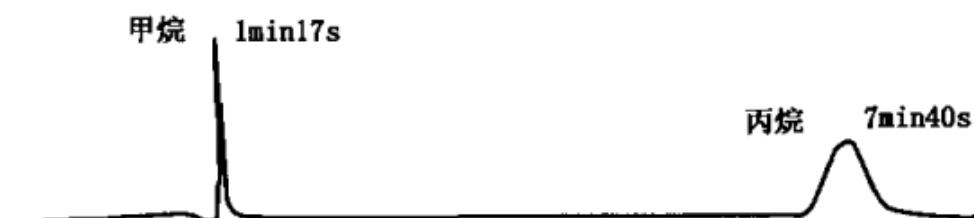
图 1 甲烷柱混合标准气色谱图 甲烷 (1.28 min); 丙烷 (7.67 min)
